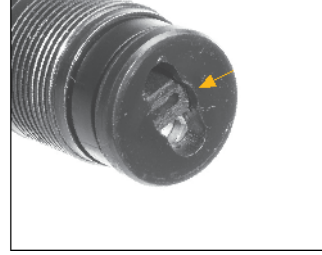
Şarjör tüpüne sabitlenmiş üç saçmalı adaptör
