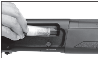
Mata in en patron genom utkastarluckan in i patronläget.
