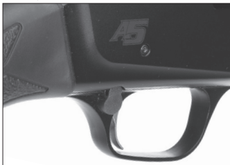
La "sicura" in posizione di sicurezza
