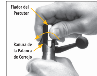
Gire la parte trasera del cerrojo en el sentido de las agujas del reloj hasta que el fiador del percutor engrane en la ranura de la palanca del cerrojo.
