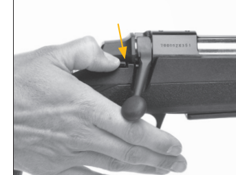
Presione el botón de activación manual del bloqueo del cerrojo y eleve la palanca del cerrojo.
