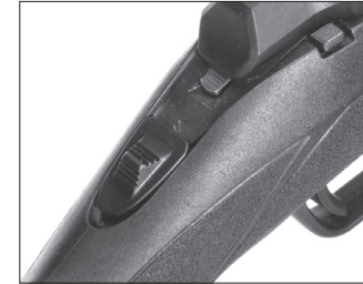
"Seguro" en posición de seguridad activada.
