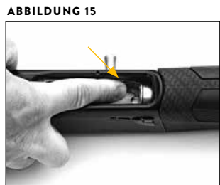
Drücken Sie den Patronenanschlag nach innen, um das Magazin zu entladen.
