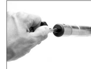
Чтобы снять ограничитель на три выстрела, используйте ключ или маленькую отвертку, нажмите и поверните его на четверть оборота
