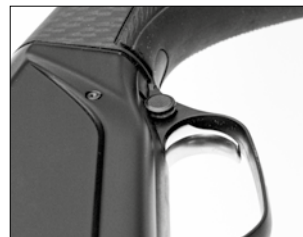
Предохранитель в боевом положении.
