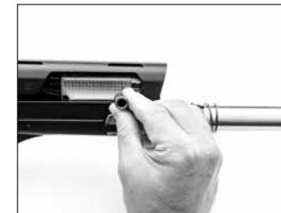
Tire hacia afuera para retirar el mango del cerrojo.
