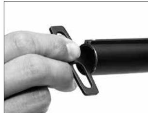
Utilice la llave del choke para cambiar los chokes.
