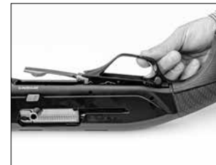
Levante la unidad del gatillo desde el cajón de mecanismos.
