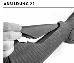
Den vorderen Teil der Schaftbacke in seinen Sitz im Schaft einführen und dann den hinteren Teil senken, um die Schaftbacke in Stellung zu bringen. Die hintere Schraube festziehen, jedoch nicht zu stark.
