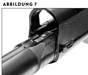
Bringen Sie die Schubstange mit dem Schlitz im Griffstück in eine Linie.
