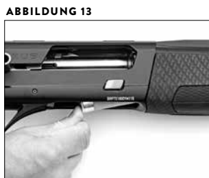
Legen Sie die Patrone in den unteren Bereich des Griffstücks und schieben Sie sie komplett nach vorn in das Magazin.
