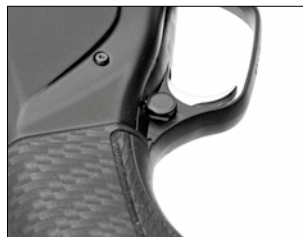
Предохранитель в безопасном положении.
