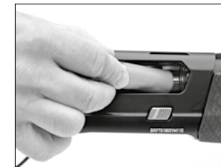
Inserire una cartuccia nella finestra di espulsione all'interno dell'otturatore.
